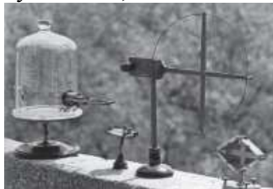
Прилад Герца для генерації електромагнітних хвиль.
