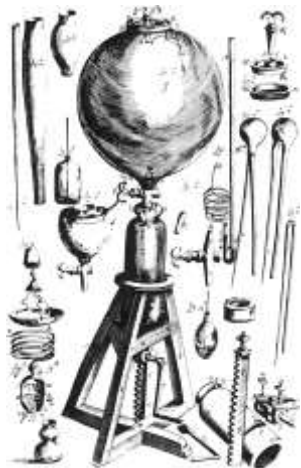
Повітряна помпа фон Геріке, вдосконалена Робертом Бойлем.
